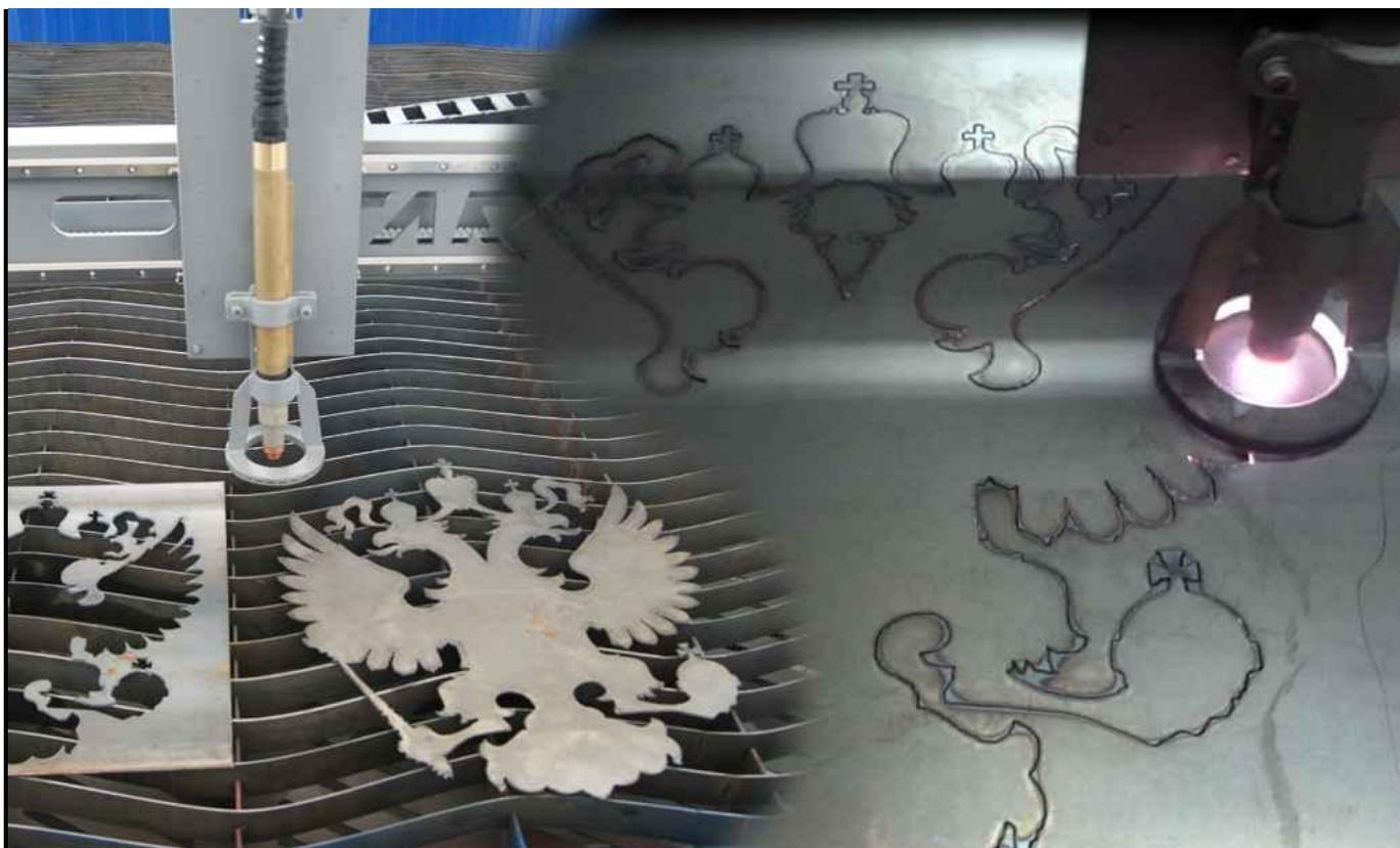
Управляется плазменный станок посредством компьютера с установленной программой Mach3. Данная программа разработана для станков с ЧПУ и характеризуется как многофункциональная и в то же время как простая в эксплуатации. Для изготовления программ управления станком может использоваться чертеж любой конфигурации, созданный в формате DXF (AutoCAD, Компас, Corel Draw и т.п.).
