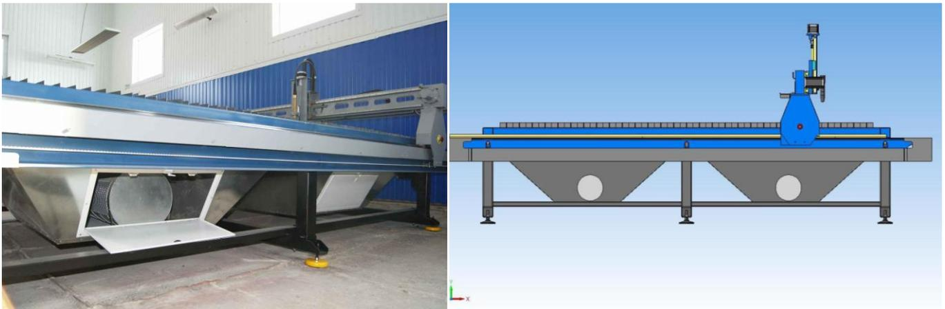
Система дымоудаления состоит из двух рабочих зон, которые могут работать как отдельно, так и совместно. При плазменной резки на небольшой площади рабочего стола можно выключить не рабочую зону вентиляции, усиливая отвод дыма в рабочей зоне. Поддоны вентиляции имеют дверки удаления шлака.
