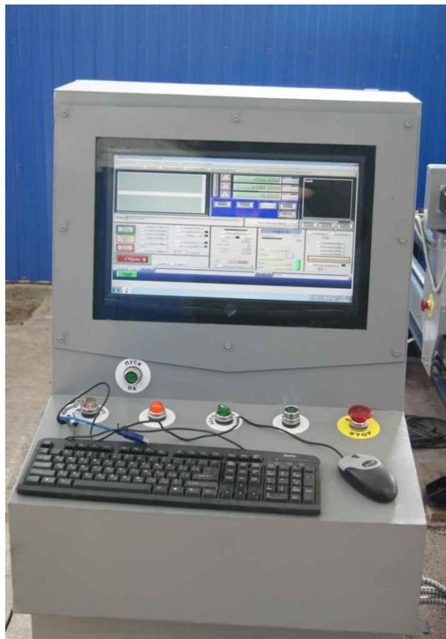
плазменного станка, индикатор включения сети, кнопка запуска плазмы в ручном режиме, переключатель режимов управления плазмой, аварийная кнопка STOP. Кабель, соединяющий пульт управления и рабочий стол станка Старт-2М, снабжён с двух сторон надёжными штепсельными разъемами и упрощает процедуру отсоединения пульта от станка. В месте подключения кабеля к станку подключен и аппарат плазменной резки.
