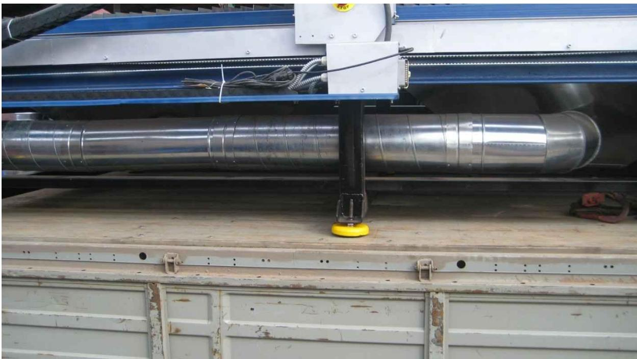
**Все поддоны оборудованы люком для удаления шлака и грязи. Конструкция вентиляционных коробов обеспечивает защиту вентиляционных отверстий по мере накопления шлака во время процесса плазменной резки и не требует частой очистки.**
