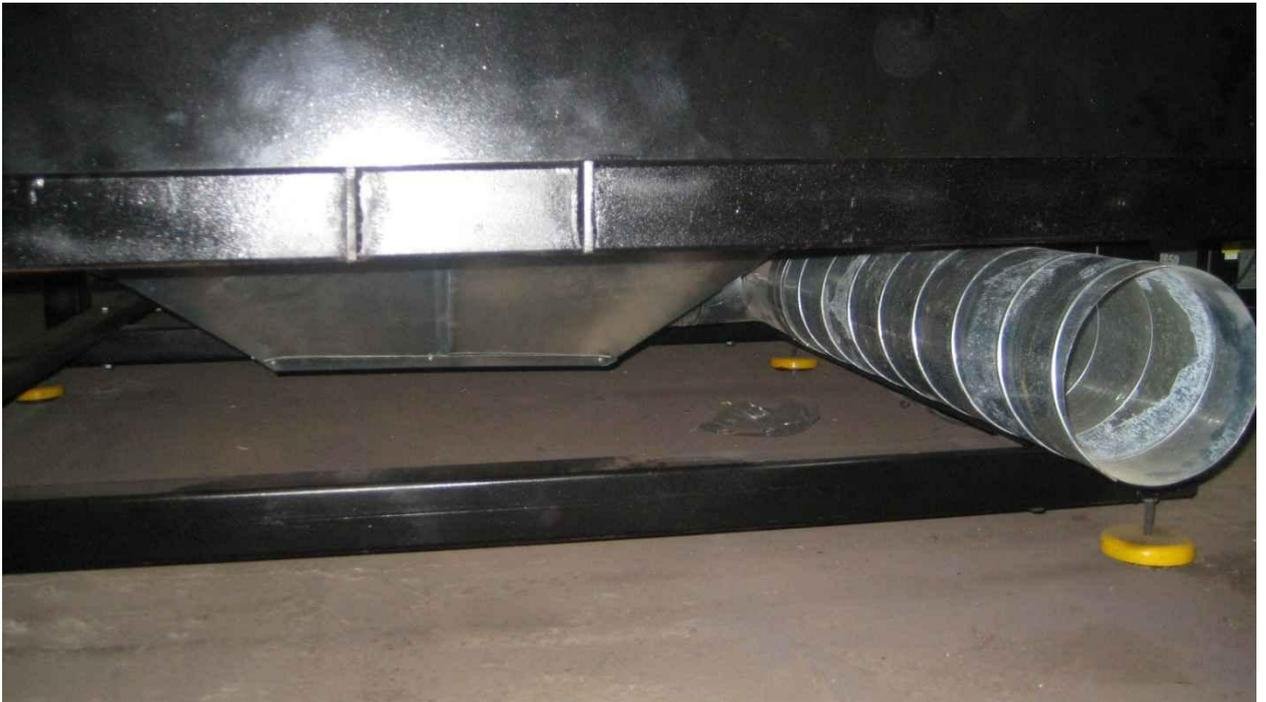
Общий выходной воздуховод, для подключения к внешней вентиляции, находится сзади станка. В дальнейшем данный воздуховод может быть вмонтирован, как в общецеховую систему вентиляции, так и в собственную. Вентилятор для собственной системы вентиляции входит в комплект станка. Вентилятор в комплекте ЦП 7-40-5,0 с эл. Дв. 5,5 кВт, 1500 об. Мин. Внешние подводимые воздуховоды должны иметь диаметром не менее 315 мм.
