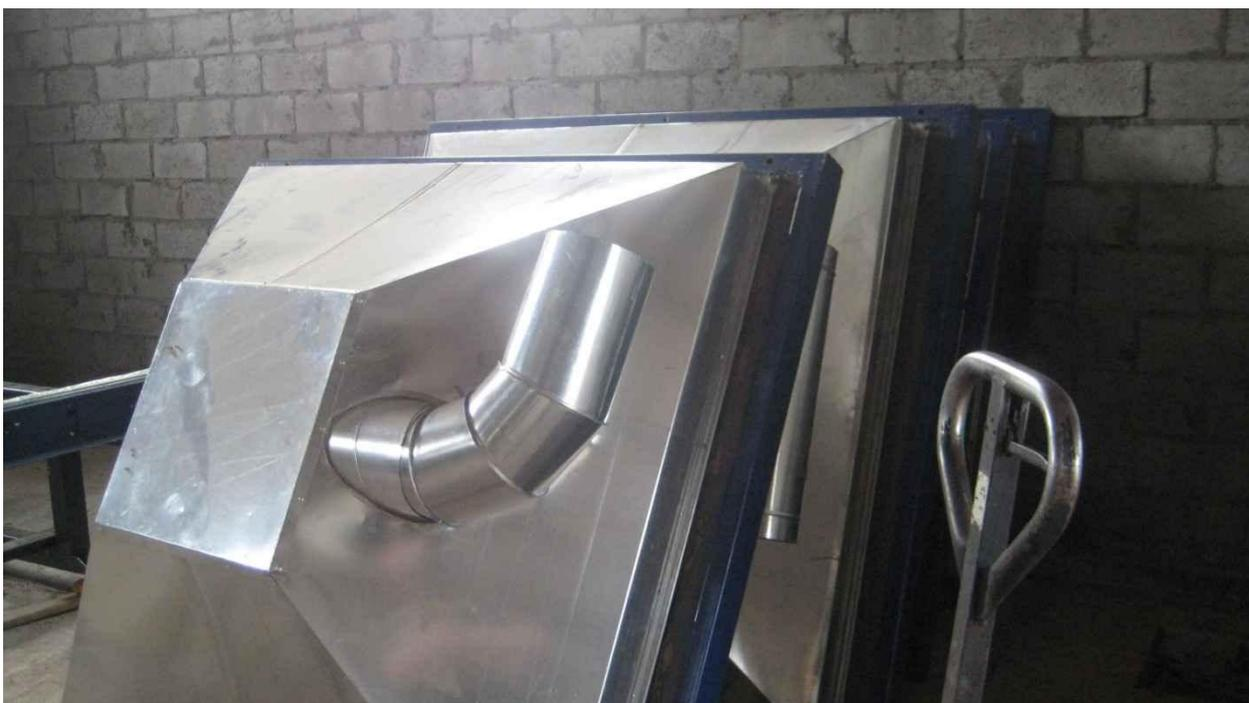
**Воздуховоды поддонов собираются в единую вентиляционную сеть станка, трубопроводы при этом выглядят как единое целое, но допускается замена коробов в случае необходимости. Система трубопроводов скрыта в габаритах плазменного станка для удобной транспортировки и легкого доступа при обслуживании и модернизации.**
