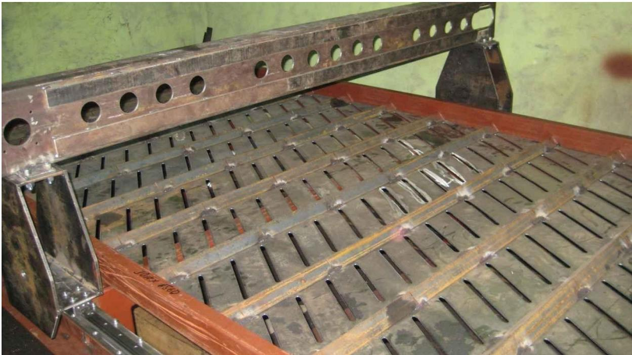
К каждому сегменту рабочей зоны крепится вентиляционный поддон с воздуховодом. Поддон представляет собой короб в виде усеченной пирамиды, с вентиляционной трубой и открывающимся люком для удаления шлака.
